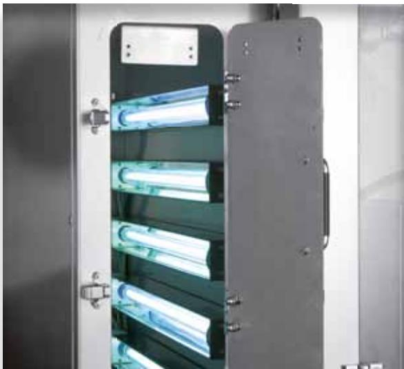
Lampade UV per abbattimento carica batterica.
